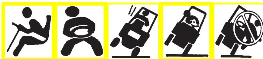
**Estacionando a Empilhadeira com Segurança:** Ao abandonar o veículo, estacione de modo seguro, mesmo que a sua ausência seja breve. Nunca deixe a empilhadeira com a carga suspensa, desça completamente os garfos de carga e incline a estrutura de elevação para frente.
