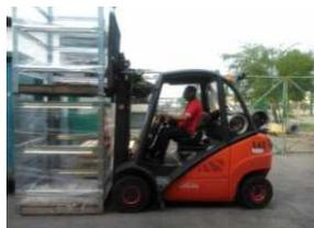
Repouse a carga devagar, ao sair observe bem o posicionamento da torre (90º), não arraste os garfos.
