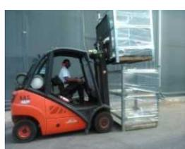
Incline a torre da empilhadeira para trás, isso aumenta a estabilidade da carga.
